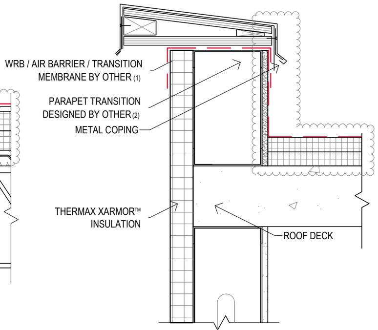
**PARAPET AT EDGE OF SLAB**
