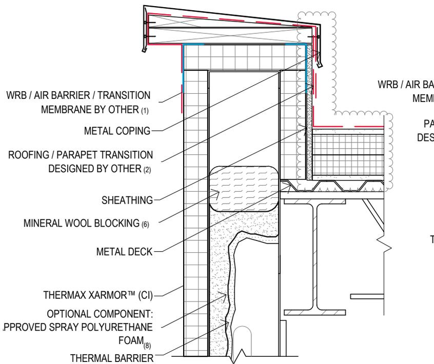
**PARAPET SPF TERMINATION WITH BLOCKING**
