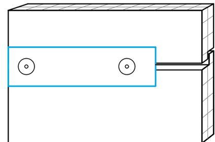
FIG 3: FASTENING @ BOARD JOINT | ISOMETRIC
