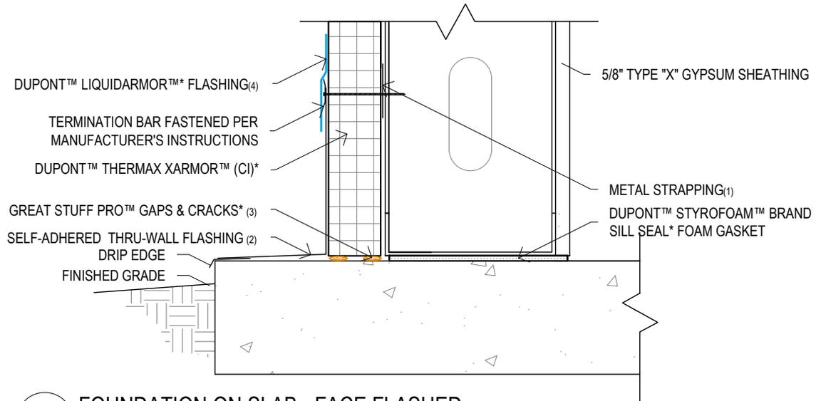
**FOUNDATION ON SLAB - FACE FLASHED**
